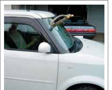
落下した枝がフロントガラスを貫通した事故
