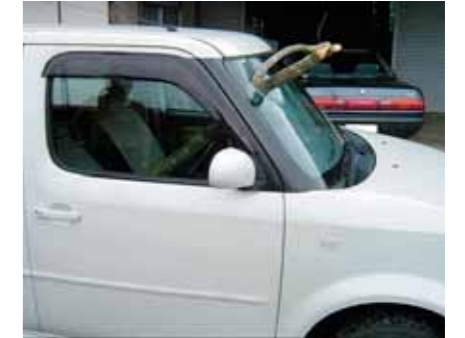
落下した枝がフロントガラスを貫通した事故
