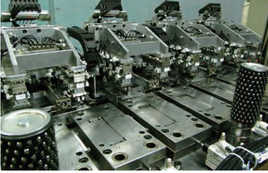
極細パイプ材のトランスファー
