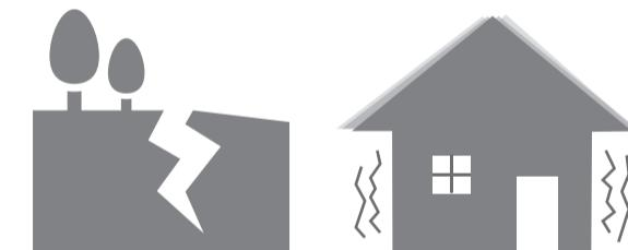
大地震が発生すると、堤防は異常な力を受けて亀裂や沈下が発生します。地震によって堤防の強度も低下しているため、水圧に耐えきれず決壊することがあります。大地震直後に決壊しなくとも、堤防が損傷している場合には、その後の余震で決壊することもあり得るので注意が必要です。
