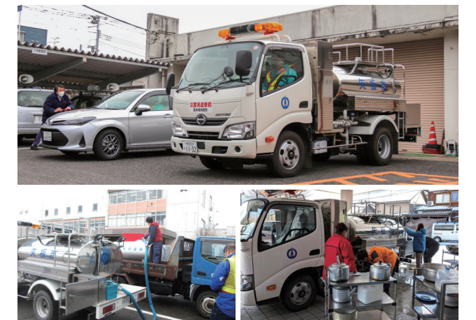
▲東日本大震災の教訓をもとに購入された圧送機能などを搭載した給水車。現地でも重宝され、被災地での給水活動に大いに貢献したようです
