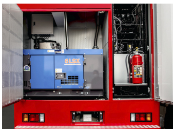
超低騒音型の発動発電機(VRシステム電源用)
