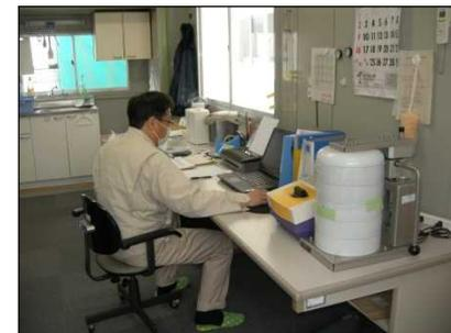
測定器で牧草の放射性セシウム濃度を測定
