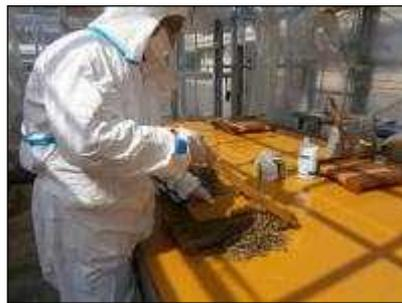
採取した牧草を細かく裁断し、検査容器に詰める
