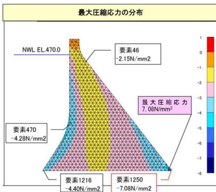
コンクリートダム地震応答解析例
