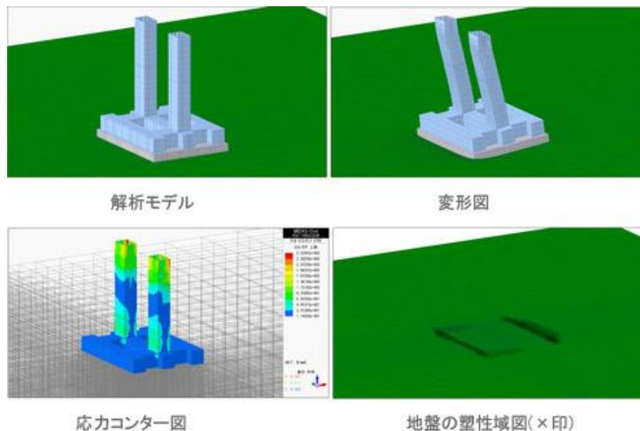
橋梁下部工地震応答解析例
