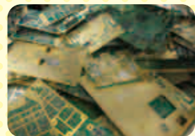
有用金属が含まれている電子基板
