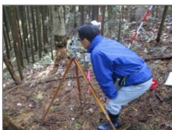
レベルコンパスによる測量の例
