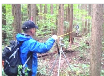
レベルコンパスによる測量の例
